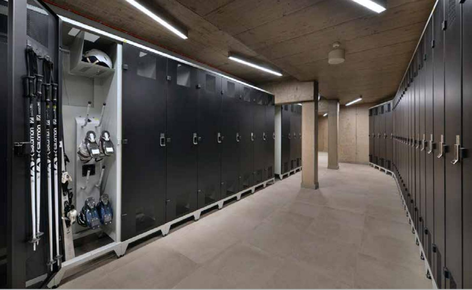
Die aus verzinktem Stahlblech verschweissten Schränke sind enorm stabil und speziell für den Einsatz in einer rauen Umgebung konzipiert. Dank der speziellen Perforierung findet eine optimale Luftzirkulation statt. Durch die nachträgliche Pulverbeschichtung des verzinkten Stahlblechs erhalten wir den höchsten Korrosionsschutz.
