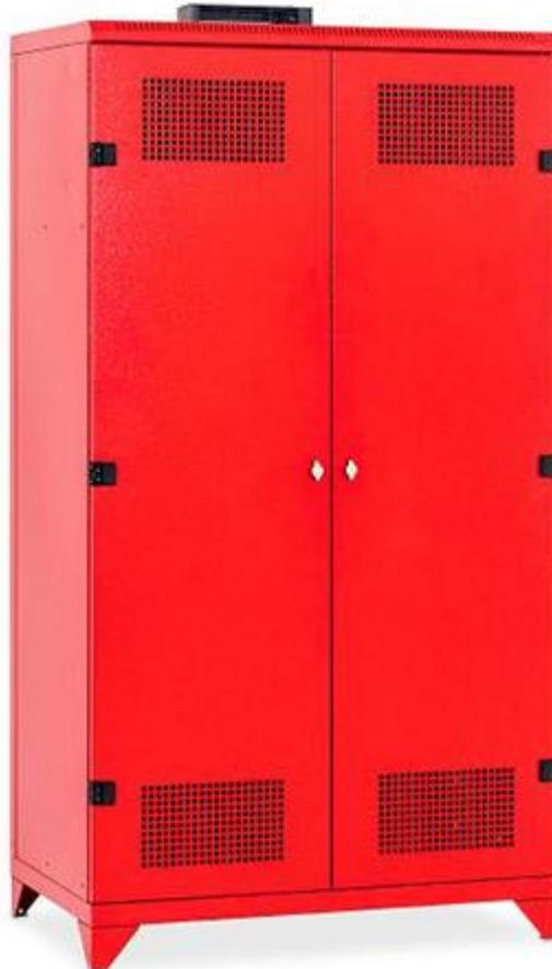
Bei den Spezialschränken für Feuerwehr und Rettungseinheiten handelt es sich um eine geschweisste Stahlblechkonstruktion aus 1 mm dickem Blech, diese Feuerwehrschrackensysteme kann man mit einem Trockner gegen Aufpreis ausstatten. Die Tür ist durch einen Drehriegel geschlossen, der einen schnellen Zugang ermöglicht. Der Boden ist perforiert und extra verstärkt. Die Schränke verfügen über ein spezielles verschliessbares Fach mit Einwurfschlitz für kleine Sachen.
