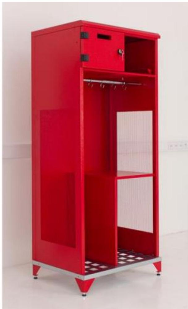
È una costruzione saldata in lamiera d'acciaio di 1 mm di spessore. Garantiscono la disponibilità immediata di indumenti di emergenza ogni volta che è necessario. Le griglie in acciaio possono essere dotate di piedini regolabili (altezza 100 mm). Con un costo aggiuntivo, gli armadietti possono essere equipaggiati con uno speciale portacasco ribaltabile. Semplicemente tirando il casco, il supporto si ripiega, rendendo molto più facile la rimozione del casco.
